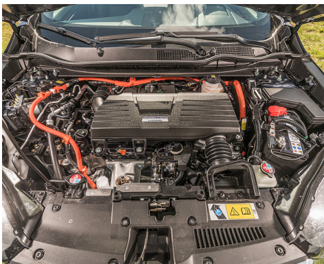
Un moteur thermique et 2 blocs électriques.
